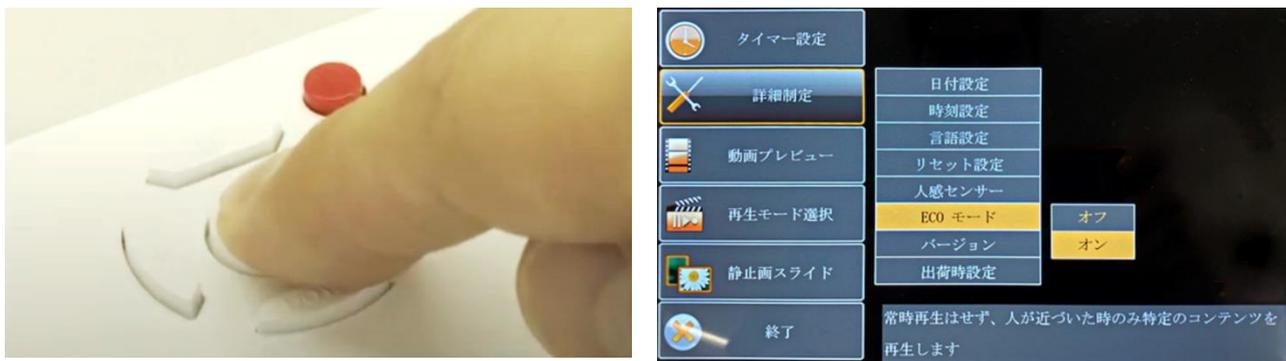
当社が開発した「ECO モード」は、人感センサー搭載サイネージに標準搭載している当社オリジナル機能です。「ECO モード」をオンにすると、センサーが人を検知した時のみ動画再生が始まり、通常は消灯状態になるため節電が可能です。「周囲に人がいないのに動画が流れている」という無駄な動画再生をなくします。
