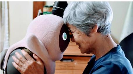
360°見渡せる半球カメラ、音声の方向も判別できる半球マイク、明るさを感知する照度センサー・かたかたを識別できる温度カメラを内蔵しているマルチセンサーホーンの他、リアルタイムに動きを生み出す意思決定エンジン、まぶたも含めて6層の映像を投影した10億通り以上の組み合わせが叶う瞳、意思を感じる一期一会の鳴き声、温かくてやわらかいボディ、スムーズな自律走行など、開発者の努力とこだわりが沢山詰まっております。
